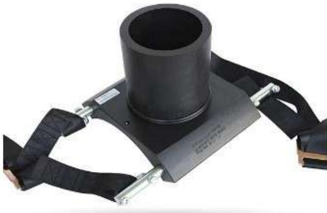
Электросварные фитинги применяются для надежного соединения пнд труб. Специальным аппаратом на закладной нагреватель подается напряжение, от которого внутренняя поверхность полиэтиленового фитинга и наружная поверхность трубы оплавляются. В итоге образуется прочное долговечное соединение.
